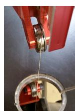
El Sistema de guiado Pégas® es fundamental para el uso de las hojas de corte Pégas®. La hoja es guiada con total precisión permitiendo obtener un alto rendimiento, con resultados de aserrado sostenibles.
