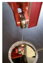
Die Pégas® Feinschnitt-Sägebänder können nur zusammen mit dem Pégas® Führungssystem verwendet werden. Dadurch verfügt das Sägeband über eine präzise Führung für leistungsstarke und effektive Sägeergebnisse.
